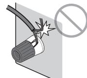
如果开启本机时在前面板显示屏上出现“Check SP Wires”，则关闭本机，然后检查音箱缆线是否短路。
